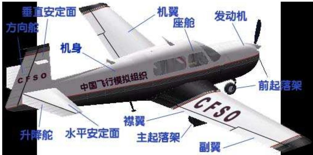
1. 机翼——机翼的主要功用是产生升力，以支持飞机在空中飞行，同时也起到一定的稳定和操纵作用。在机翼上一般安装有副翼和襟翼，操纵副翼可使飞机滚转，放下襟翼可使升力增大。机翼上还可安装发动机、起落架和油箱等。不同用途的飞机其机翼形状、大小也各有不同。
