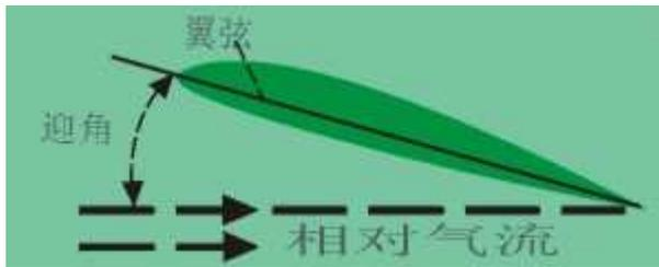
1. 迎角对升力和阻力的影响——相对气流方向与翼弦所夹的角度叫迎角。在飞行速度等其它条件相同的情况下，得到最大升力的迎角，叫做临界迎角。在小于临界迎角范围内增大迎角，升力增大；超过临界迎角后，再增大迎角，升力反而减小。迎角增大，阻力也越大，迎角越大，阻力增加越多；超过临界迎角，阻力急剧增大。
